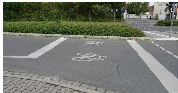
Abbildung 29: Fehlender Aufstellbereich an einer Kreuzung (links) und markierter Aufstellbereich (rechts) (Hinweis: Bilder nicht aus dem Sorepeland)
